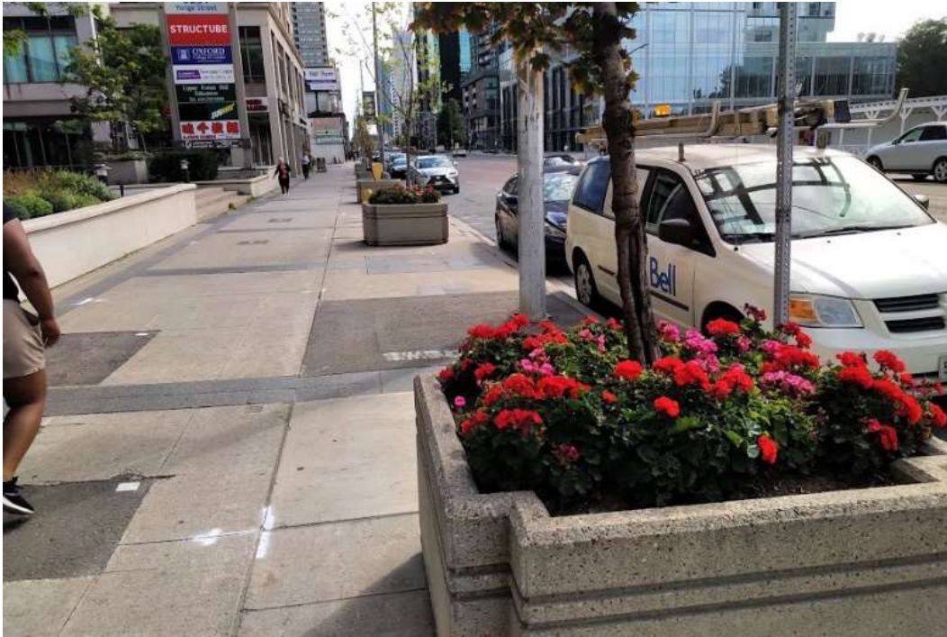
Figure 7 – Exemple d'un moyen de réduction du risque aux cibles vulnérables, les jardinières de ciment peuvent agir comme barrières afin de prévenir des attaques en véhicule sur les trottoirs, rue Yonge, Toronto, datée du 25 septembre 2019. Photo par Jack Rozdilsky.
